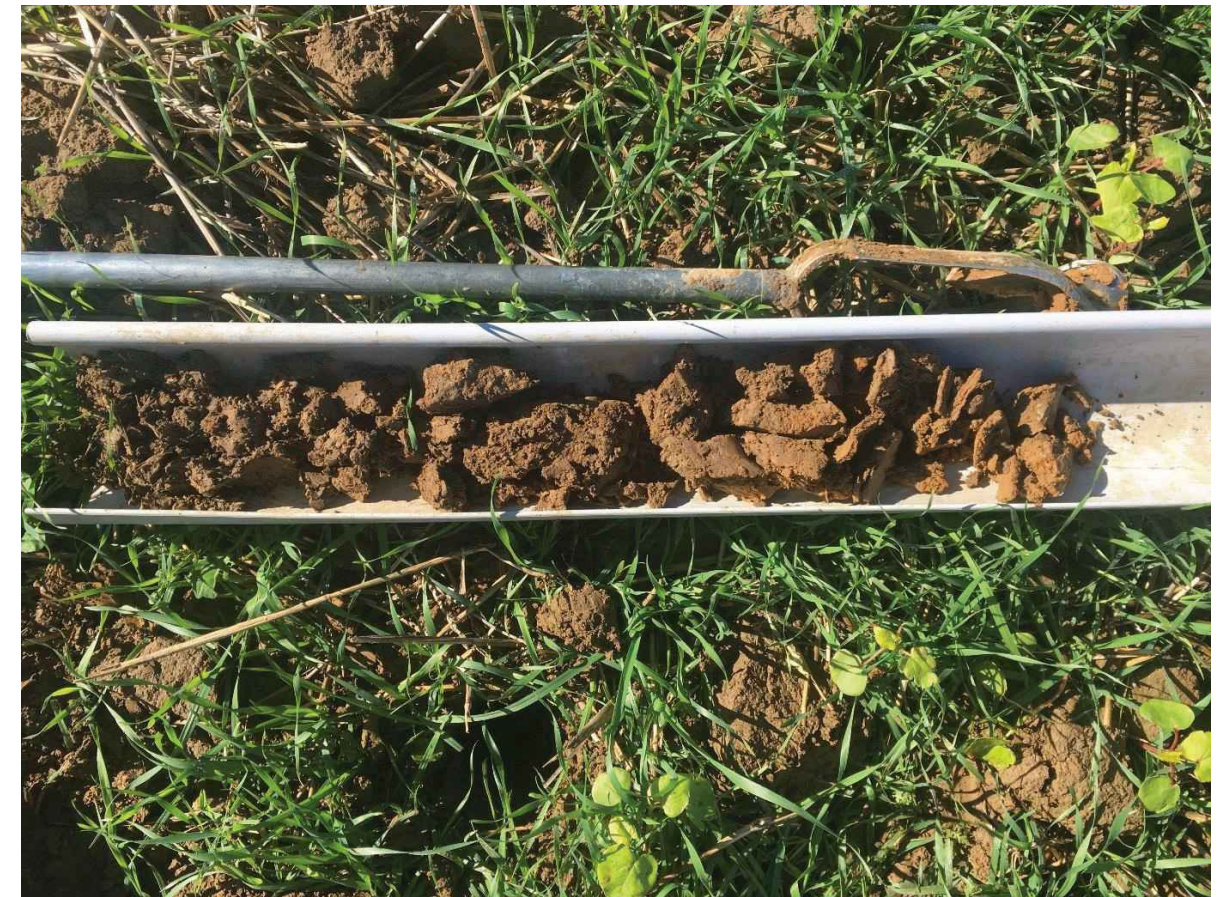
Figure 23 : Profil typique des sondages sans trace d'hydromorphie.
